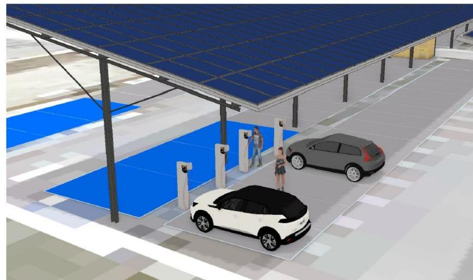
Figure 31 - Bornes IRVE installées sous les ombrières
